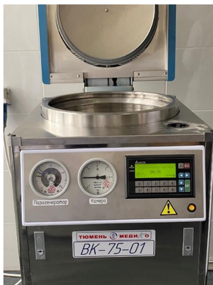
4 Сурет – Ыдыстарды стерильдеуге арналған Автоклав
